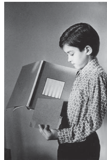
Рис. 3.3. Измерение частотно-контрастной чувствительности глаза. Атлас тестовых изображений содержит разные пространственные частоты. Каждая частота на отдельном листе атласа. Контраст от нулевого сверху нарастает к единичному внизу решетки. С помощью маски исследователь предъявляет разный контраст для данной пространственной частоты
