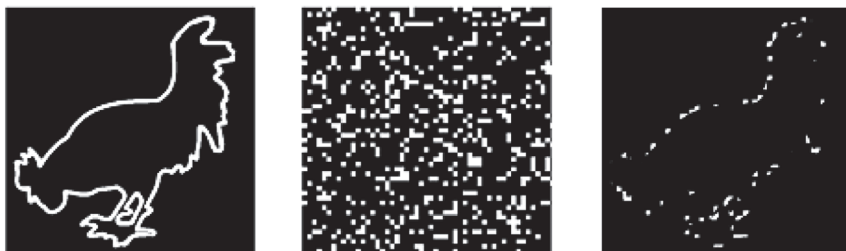
Рис. 8.1. Принцип формирования фрагментированных тестовых изображений. Слева — исходный объект; в центре — маска с переменной статистикой (плотностью окон, через которые наблюдатель видит исходный объект); справа — видимое изображение при заданной плотности распределения окон
