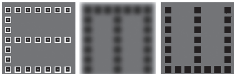
Рис. 7.4. Примеры фрагментированных символов Э Ш М Е . После фрагментации и высокочастотной фильтрации (слева), низкочастотной (в центре) фильтрации исходного нефильтрованного, но фрагментированного символа
