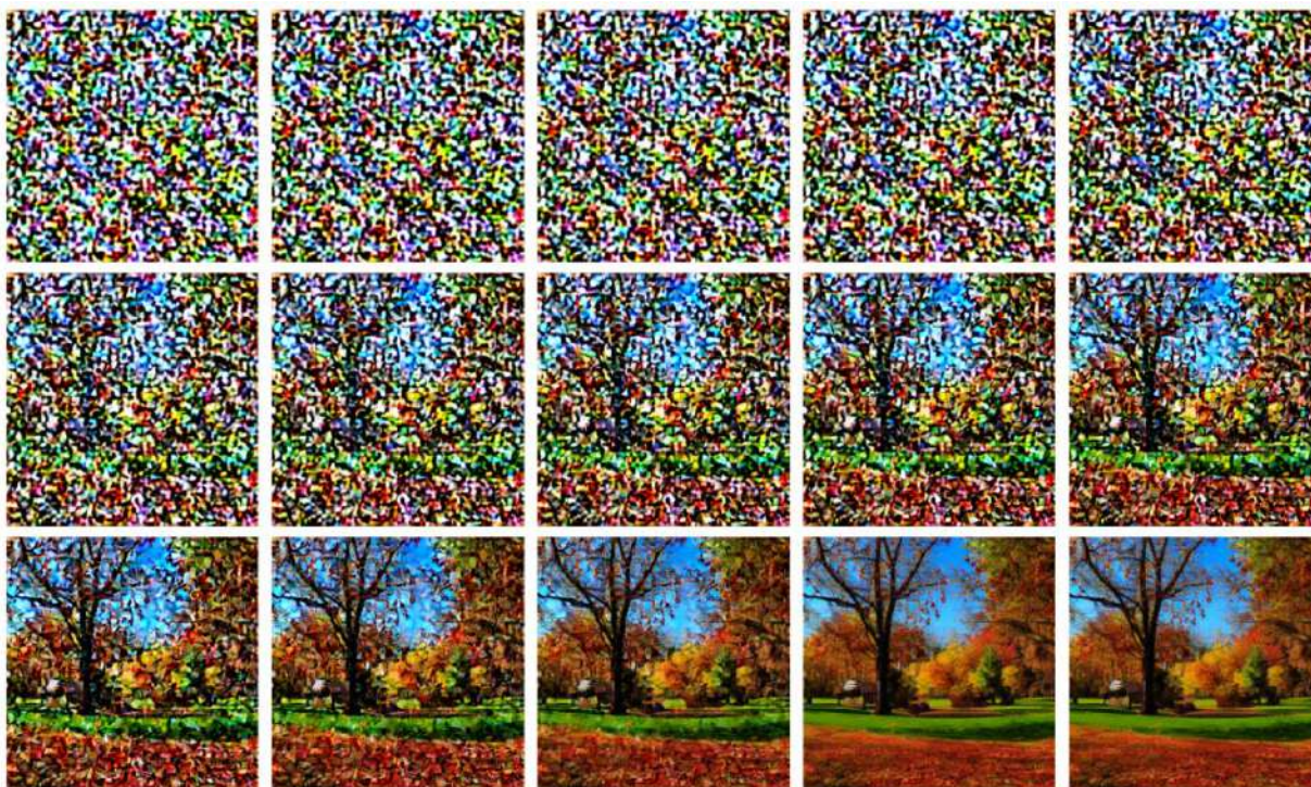
Рисунок 56. Пример создания изображения диффузионными моделями, путем пошагового вычитания шума
