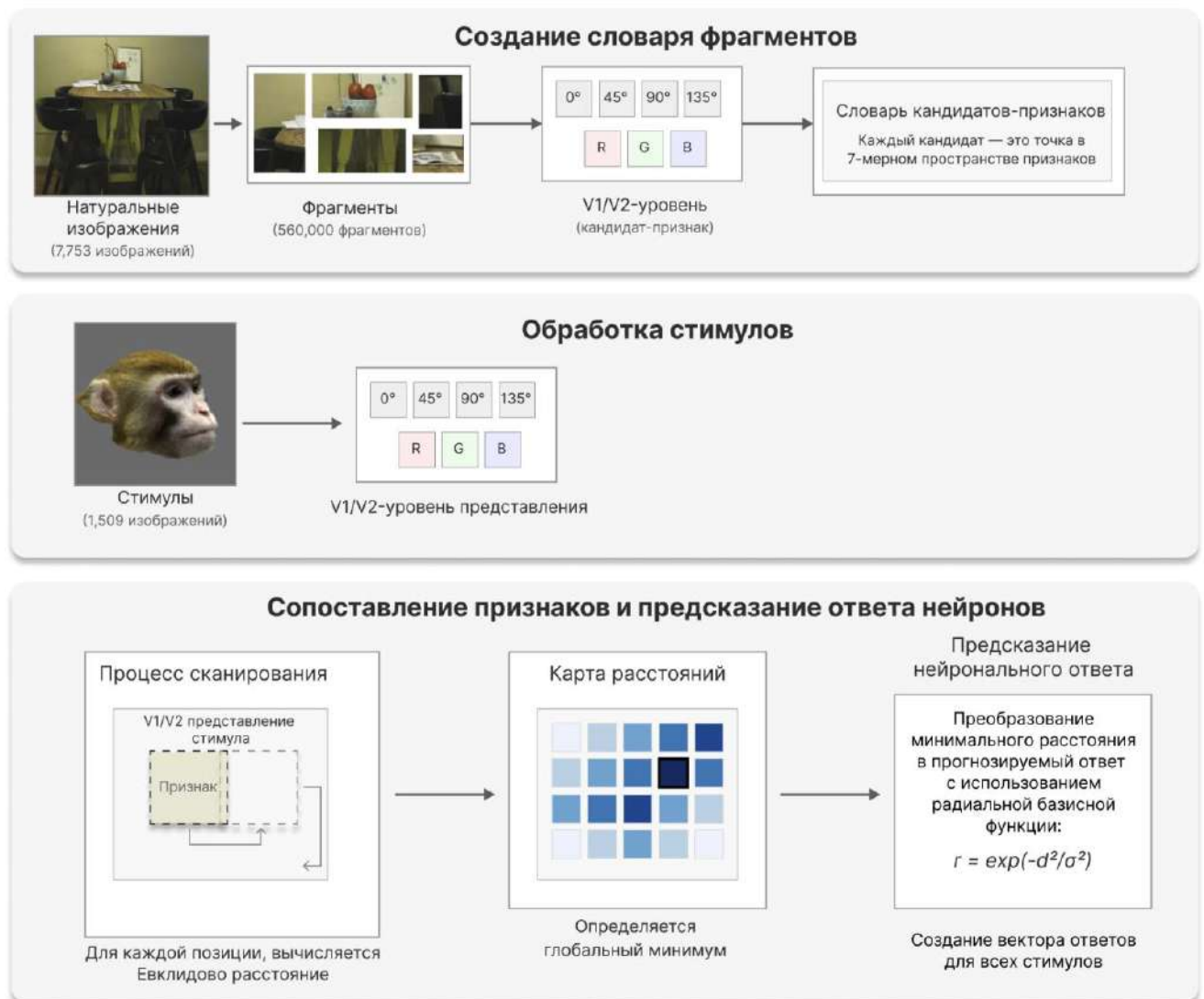
Рисунок 49. Схема ИНС для интерпретации и аппроксимации функции нейронов через набор комбинаций признаков в пространстве локальных ориентаций и цветов
